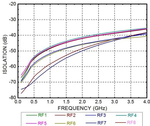
RFC-RFX 隔离度 (对向端口导通)
