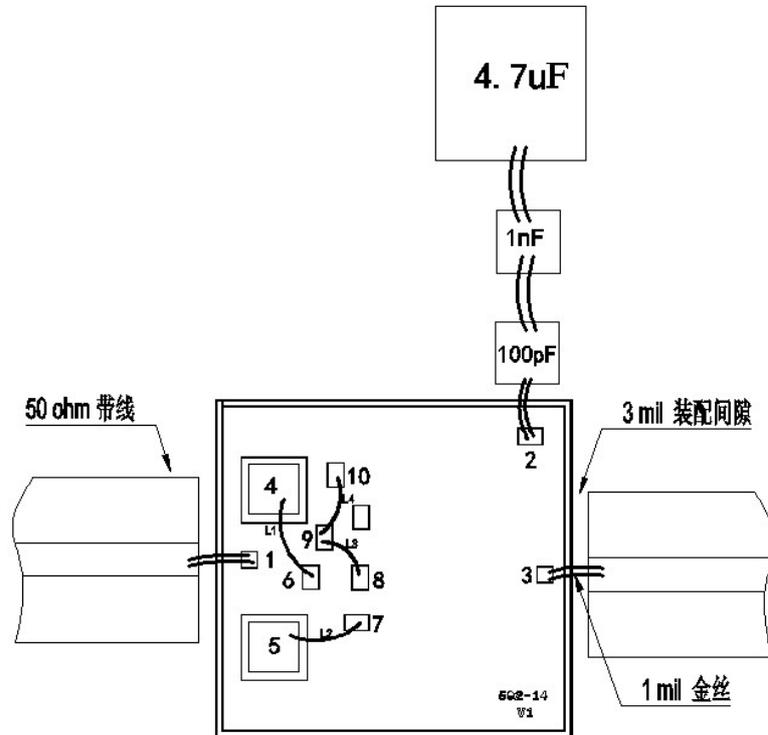
装配说明：变容二极管通过导电胶粘接在焊盘“4”与“5”处，并将变容二极管的正极通过金丝 L1 与 L2 键合到焊盘“6”与“7”处，在焊盘“8”与“9”键合一根 700um 金丝 L3，在焊盘“9”与“10”键合一根 700um 金丝 L4；**注意金丝 L3 与 L4 长度必须达到 700um，否则会出现低频处不震荡现象。**
